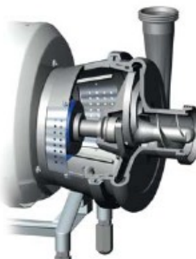
Version spéciale équipée d'un Inducteur dans l'orifice de succion. Ce dispositif est installé immédiatement en amont du rotor pour réduire le NPSH nécessaire pour la pompe.
